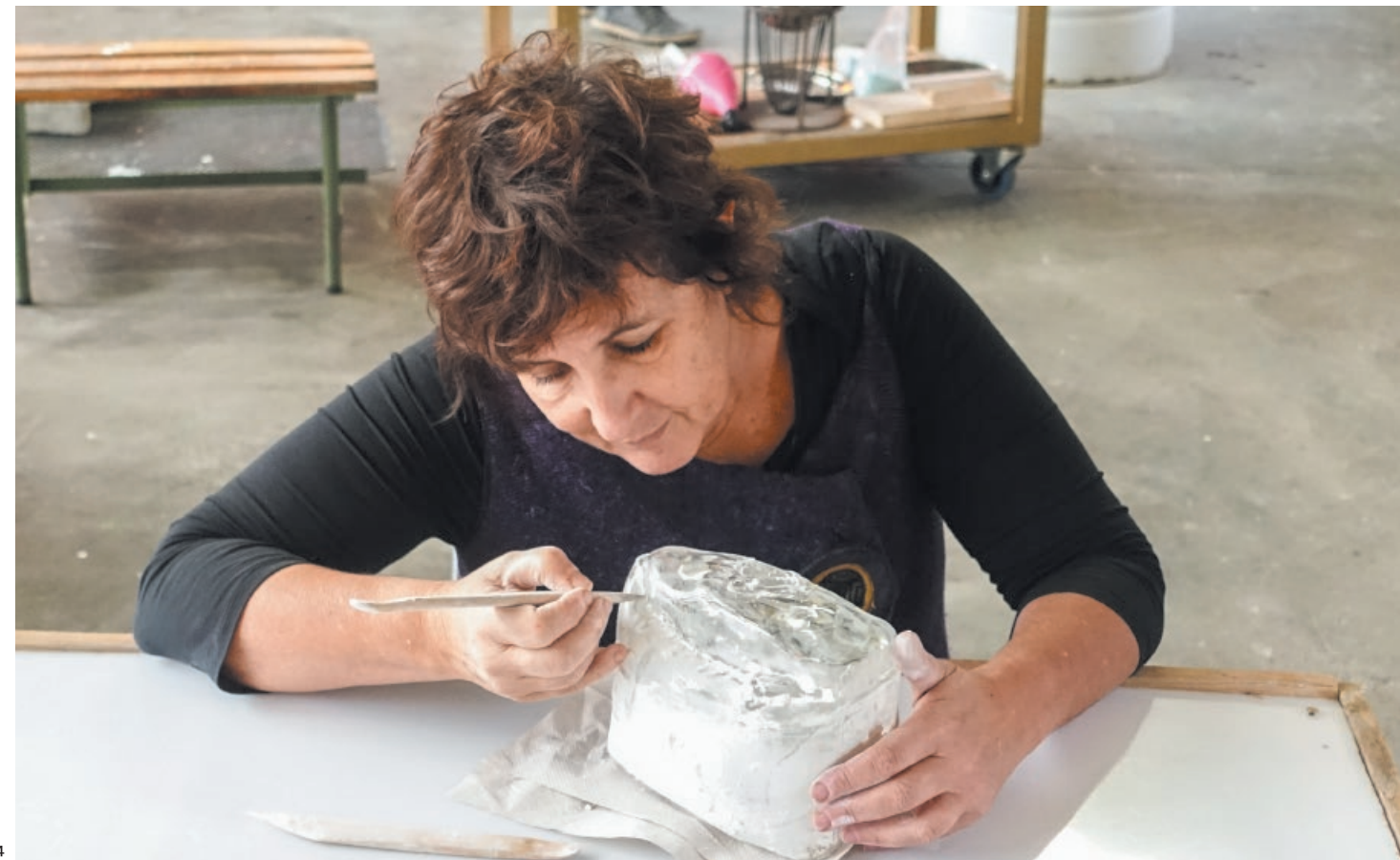
1. Das Modell, ein Schwimmflügel, wird für die Gipsform vorbereitet / The model, a floatie, is being prepared for the plaster mold 2. Die Gipsform entsteht / Silvia Levenson creates the plaster mold 3. Ein heißer Glaskörper wird in die Form eingeführt und weiter geblasen / Hot glass is being insterted into the mold and blown 4. Levenson legt den gläsernen Schwimmflügel frei / Levenson is uncovering the glass floatie
